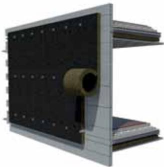
Fixation de l'isolant à la verticale
