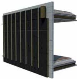
Fixation horizontale de l'isolant et ossature
